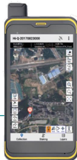
El Qmini A5/A7 es un dispositivo "todo en uno" como smart phone y colector de datos. Su diseño ergonómico y ligero es fácil de llevar, su antena espiral y el GNSS RTK algoritmo de Hi-Target proporcionan alta precisión. Con software incorporado, los A5/A7 pueden efectuar varias operaciones, incluyendo inspección de recursos de agua y tierra, inspección de tuberías, medioambientales y otros trabajos públicos.
