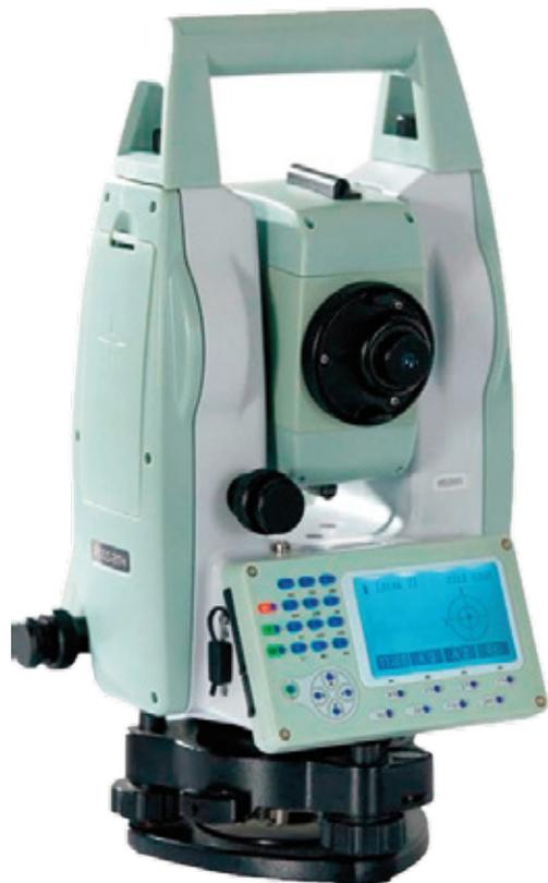
**Medición Angular:** precisión a 2"
