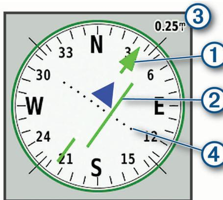
El puntero de trayecto (1) indica tu relación con la línea de trayecto que conduce al destino. El indicador de desvío de trayecto (CDI) (2) proporciona la indicación de desvío (derecha o izquierda) de trayecto. La escala (3) corresponde a la distancia existente entre los puntos (4) del indicador de desvío de trayecto, que te indica a cuánta distancia de desvío de trayecto estás.
