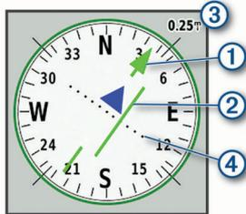
El puntero de trayecto ① indica tu relación con la línea de trayecto que conduce al destino. El indicador de desvío de trayecto (CDI) ② proporciona la indicación de desvío (derecha o izquierda) de trayecto. La escala ③ corresponde a la distancia existente entre los puntos ④ del indicador de desvío de trayecto, que te indica a cuánta distancia de desvío de trayecto estás.
